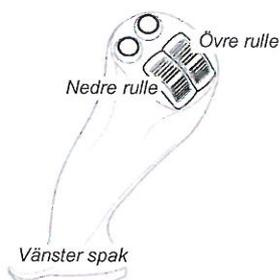
**Inre/Yttre** – När två rullar är vertikalt monterade på samma spak används benämningen inre respektive yttre rulle. Inre rulle är den rulle som är monterad närmast föraren (se bild)
